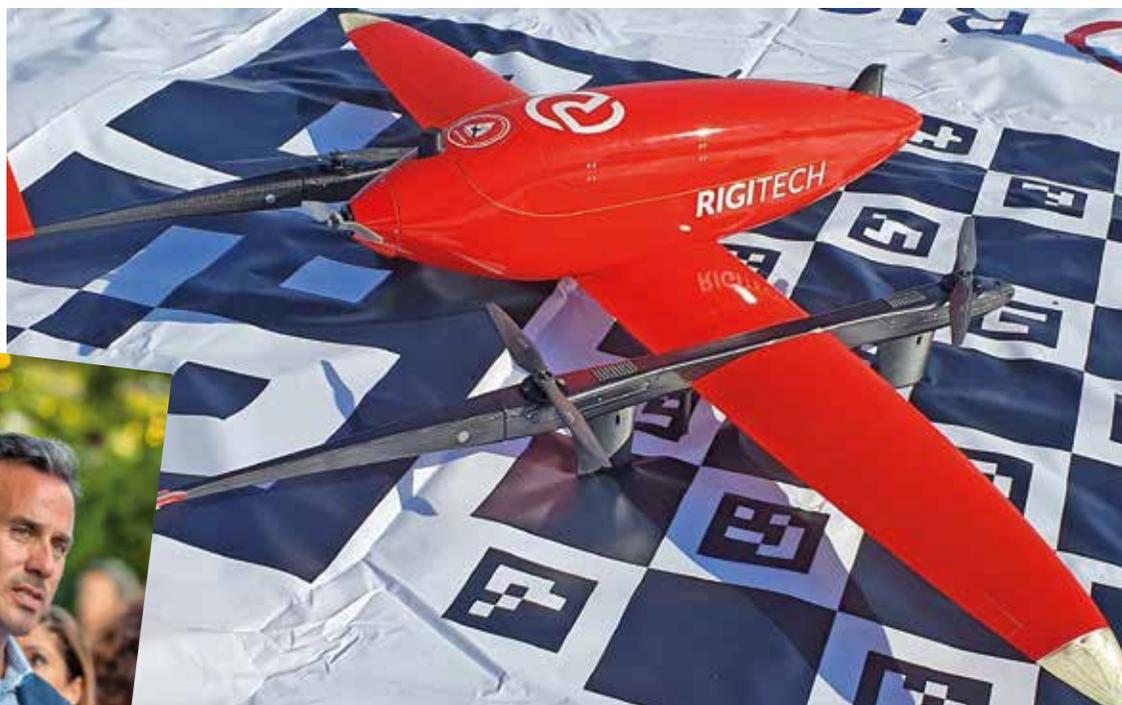
Le drone peut voler à 120 km/h. Il pèse 19 kilos une fois chargé de 150 échantillons de sang ou d'urine. Alessandro Keller, directeur général d'Unilabs. (Photo: sp)
