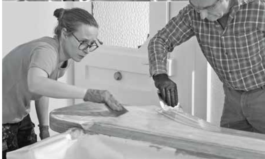
Ci-dessus, Fabien et sa fille Camille en train d'entoiler la dérive. En haut, Anne Vuillème-Laes-ser dans la coque retournée de Cagaya . (Photos dr)
