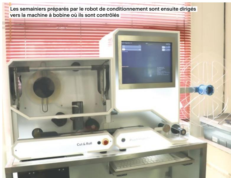
Les semainiers préparés par le robot de conditionnement sont ensuite dirigés vers la machine à bobine où ils sont contrôlés
